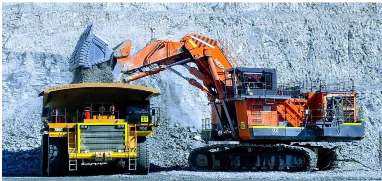
Сурет 1.5 - Hitachi-3600 экскаваторының Caterpillar 785C автосамосвалына пайдалы қазбаны тиеу барысы
